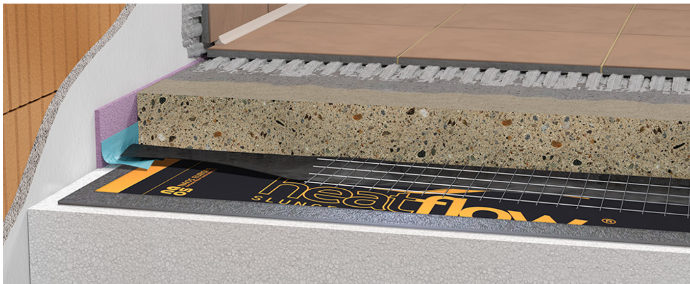
Celoplošné podlahové topení s poloakumulační vrstvou ANHYLEVEL
